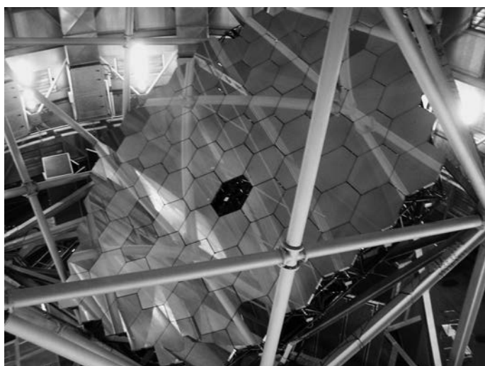
Составное зеркало телескопа SALT. Виден отсутствующий сегмент, который снят для обновления зеркального покрытия.
