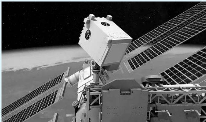
Прибор “NICER” на платформе ELC-2, установленный на внешней поверхности МКС. Фото NASA.
