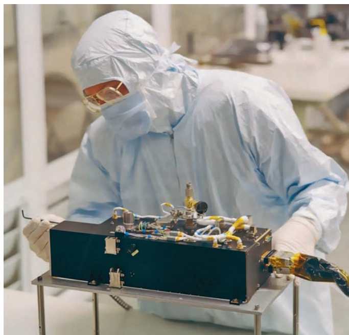
Сборка спектрографа ALICE. Фото ESA.
